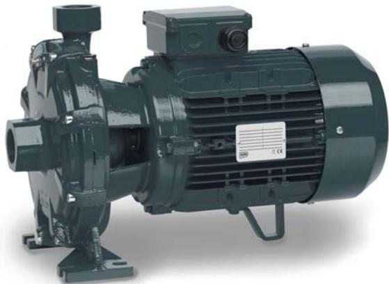
Насосы серии 2СМ используются для повышения давления воды и других неагрессивных жидкостей. Имеют плавную напорно-расходную характеристику, что позволяет применять насосы в большом диапазоне подачи воды при незначительном изменении выходного давления. Главная особенность конструкции заключается в последовательном расположении двух рабочих колес, что позволяет достигать большей высоты водяного столба по сравнению с одноступенчатыми насосами.
