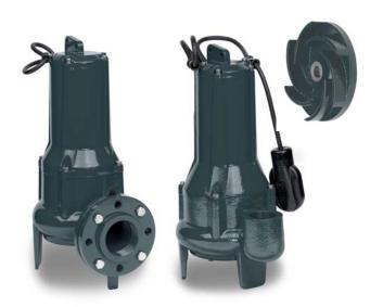
Погружные дренажные насосы PRF-V, PRT-V, SET-V, SEM-V оснащены рабочим колесом типа VORTEX, которое позволяет пропускать взвешенные частицы. Применяется в бытовых и промышленных условиях для выкачивания маслянистых и химических жидкостей из выгребных ям, для откачки воды, загрязненной твердыми и волокнистыми включениями, в том числе сточных вод. PRF-V имеет фланцевые соединения, PRT-V, PRM-V, SET-V, SEM-V – резьбовые.
