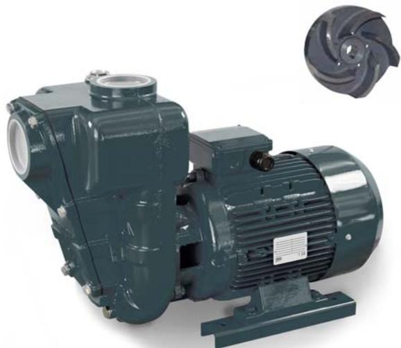
Самовсасывающие насосы с открытым рабочим колесом. В конструкции насоса установлен обратный клапан, что позволяет избежать эффекта сифона при выключении насоса в режиме всасывания. Насосная часть остается заполненной жидкостью, что позволяет избежать работы насоса «всухую» при запуске. Насос подходит для чистой или слегка загрязненной воды, для дренажных систем и систем полива.
