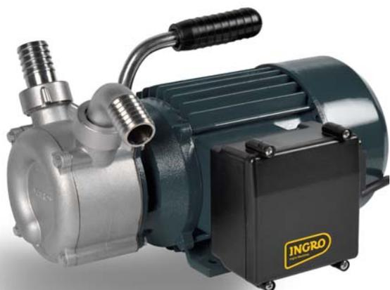
Насосы серии РМ предназначены для перекачивания чистых и слабоагрессивных жидкостей, не содержащих песка и других твердых частиц. Также насосы подходят для перекачивания питьевой воды, вина, уксуса, сока и других пищевых жидкостей. Электрический мотор со встроенным в клеммную коробку переключателем позволяет менять направление вращения двигателя и рабочего колеса, что позволяет получить изменение направления движения жидкости от напорного патрубка к всасывающему патрубку и наоборот.
